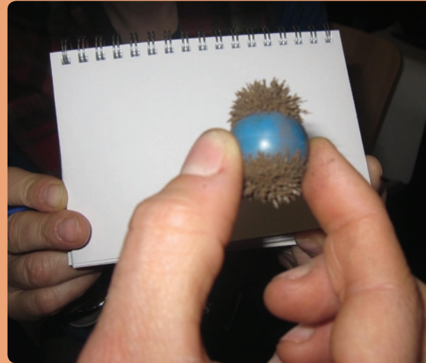
Figura 13: Los polos corresponden a la zona con más limaduras, ya que es la zona con mayor densidad de líneas de fuerza.
