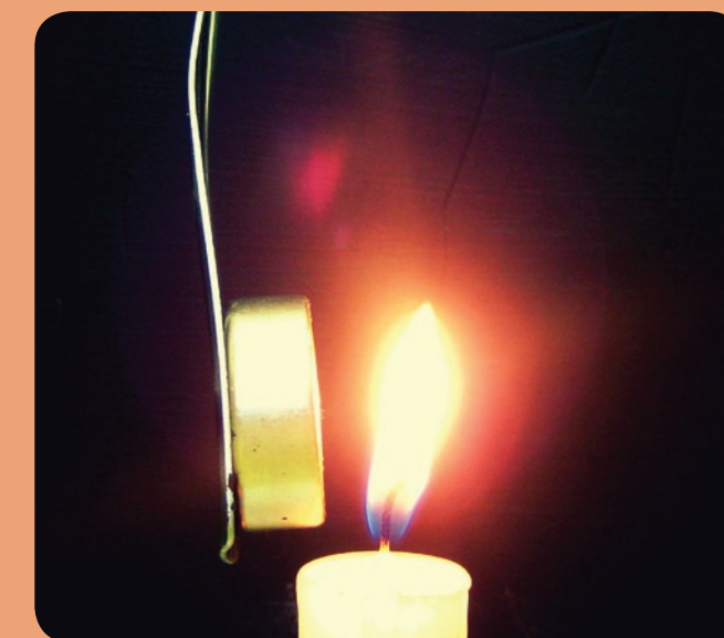
Figura 24: La flama de l'espelma vertical sense l'imant. Figura 25: L'espelma desviada quan l'imant és a prop.
