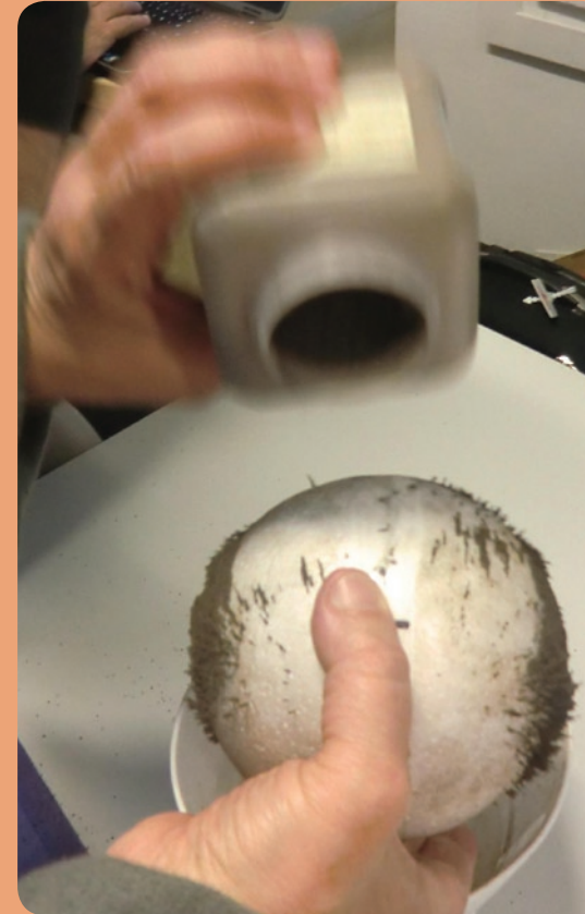
Figures 15 i 16: Les llimadures de ferro sobre la terra imantada marcaran la direcció dels pols i com recolliran més llimadures en aquesta zona que a l'Equador, és podrà comprovar que el camp magnètic és més fort a els pols que l'Equador.
